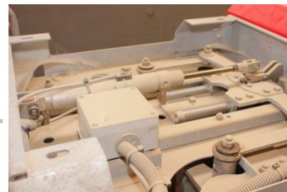
Indgangslågens lukkehastighed og -kraft kan normalt indstilles øverst på foderstationen
