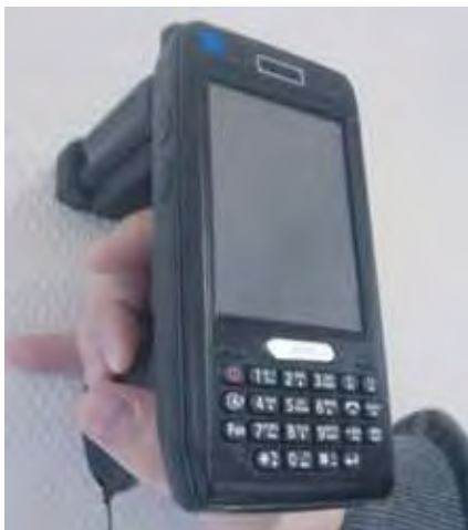
Billede 1. Håndholdt scanner til registrering af vægt og andre registreringer på grisen.
