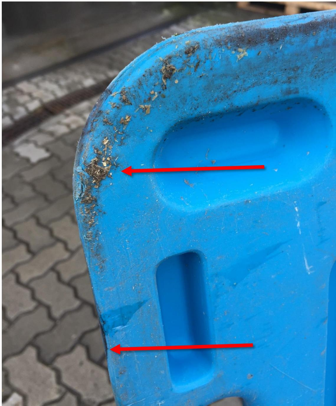
Figur 7. Drivbræt med skidt på og revner i skal kasseres (iflg. DANISH Transportstandard).
