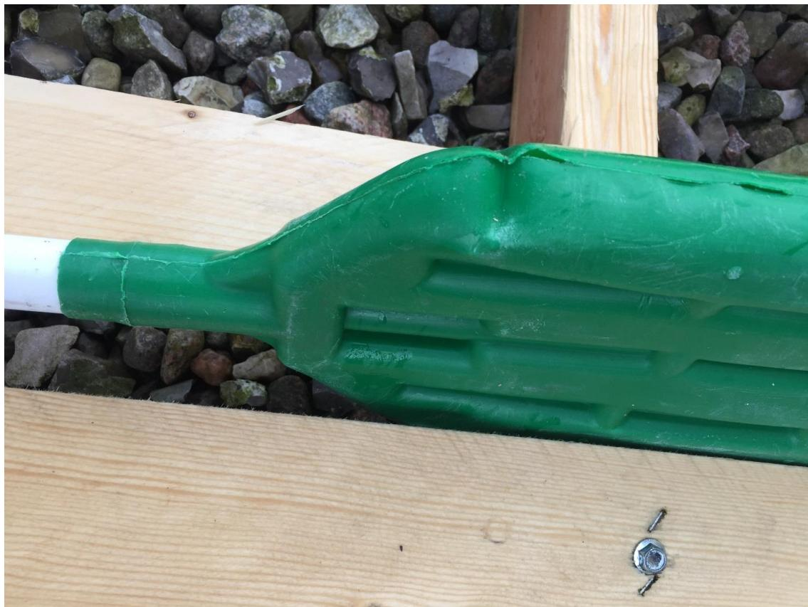
Figur 6. Paddel, der er revnet, kan ikke garanteres ren indvendig og skal kasseres (iflg. DANISH Transportstandard).
