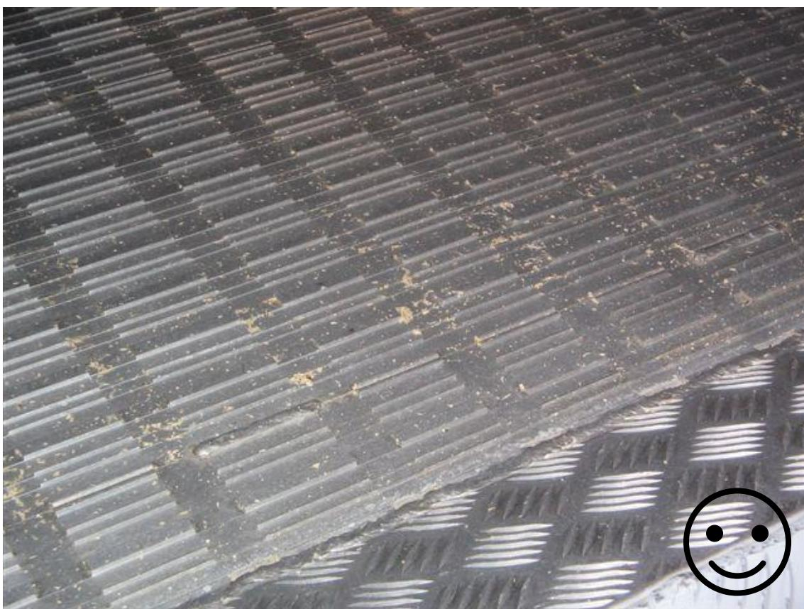
Figur 13. Opsprøjt af rene spåner - OK (fordi det er rene spåner). Skylles ud med desinfektionsvæsken.
