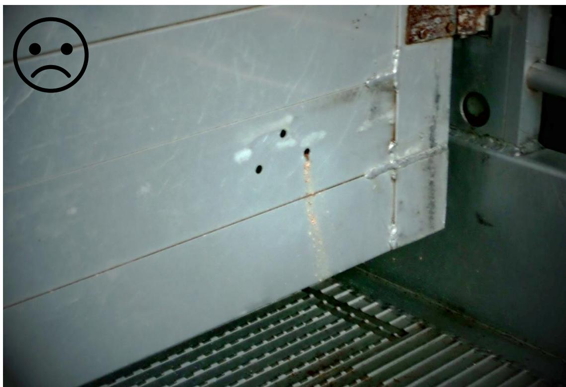
Figur 17. Skillevæg med huller – AFVIST. Der er tydeligvis skidt inde i skillevæggen.
