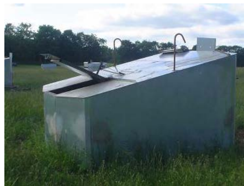
Foto 4. Automatisk ventilationsåbner i 3. generation stålhytte.
