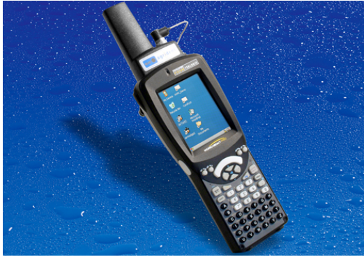
Figur 2. PSION WORKABOUT PRO med antenne til aflæsning af elektroniske øremærker. Læseafstanden med denne antenne er ca. 15-20 cm. Enheden er forsynet med stik til ekstra stavantenne, som kan forlænge læseafstanden op til 1 meter.
