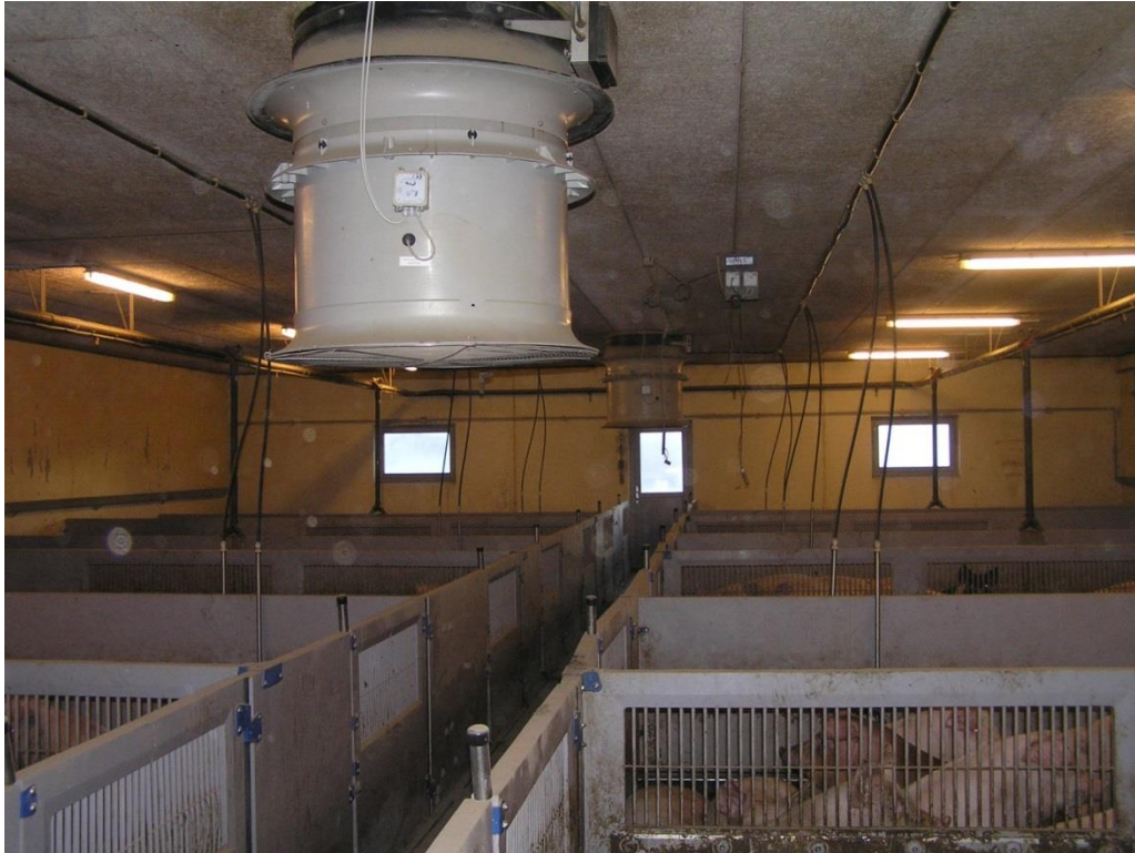
Billede A1. Forsøgssektion der blev anvendt i afprøvningen. På billedet ses bl.a. målevingerne, der var placeret under indløbstragten for ventilationsafkastet.
