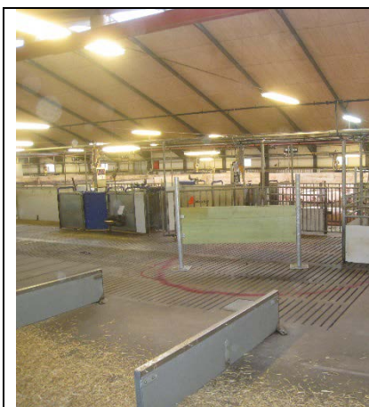
Figur 4. I 2 af stierne var der et drængulvselement på gødearealet, i forlængelse af gødevæggen. Det kan anes til venstre på fotoet. Dette var utilsigtet og er vist, fordi resultaterne indikerer, at dette kan være af betydning.
