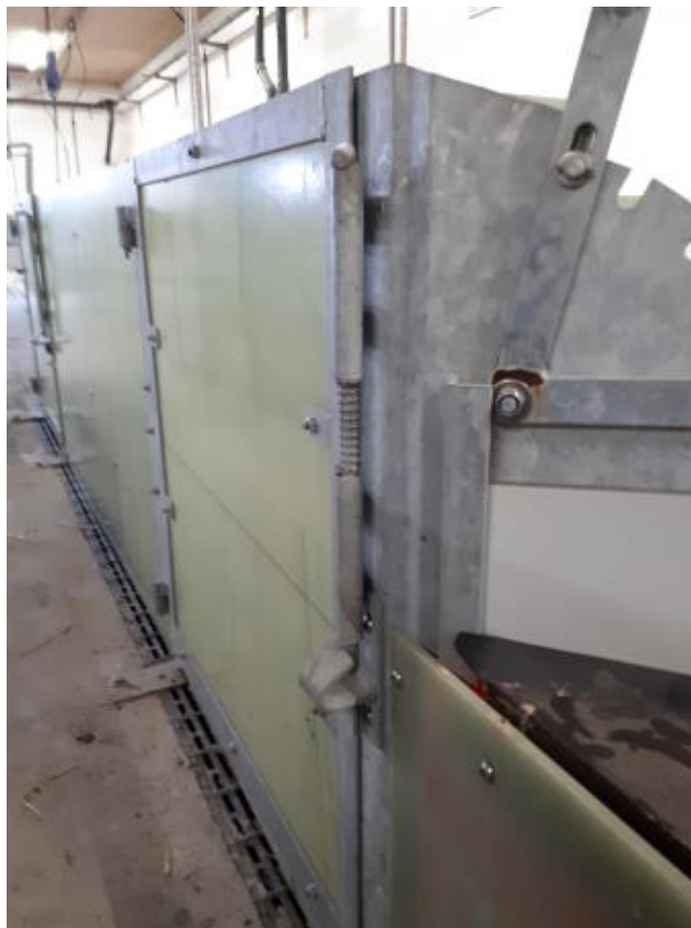
Figur 5. Eksempel på håndtag, der kunne betjenes med én hånd, og hvor lågen "smækkede", når den skulle lukkes (Jyden).
