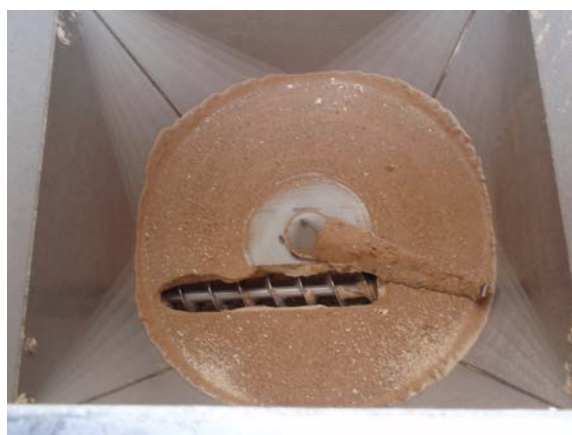
Foto 1.34 Påslaget skal have omrører og ret stejle sider, da ensileret kernemajs er et relativt "dødt" materiale, der let danner bro.
