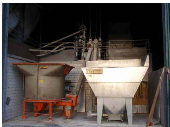
Foto 1.33 Påslag til ensileret kernemajs, som påfyldes med frontskovl. Majsens snegles direkte til vådfoderkar på vejeceller.
