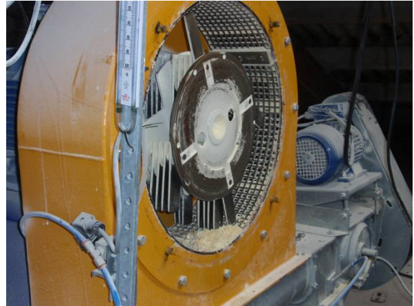
Foto 1.11 Majsene blev formalet på en SKIOLD hammermølle RVO-M 280056 med afstrygere på soldet for at forebygge tilstopning.
