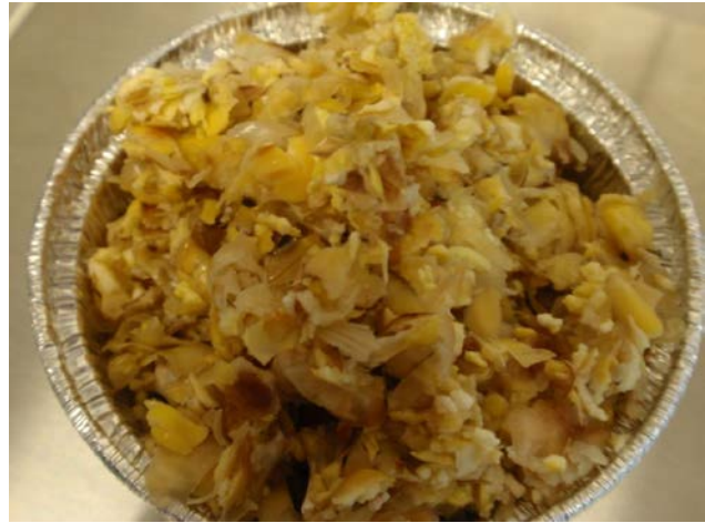
Foto 2. Vådsigtning af crimpet majs resulterede i en stor andel af prøven i den groveste kategori. Det er sandsynligt, at andelen var for stor, fordi det var vanskeligt at sigte skallerne korrekt.
