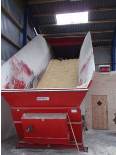
Foto 1.35 Cormall fuldfoderblender på vejeceller anvendt som påslag til ensileret kernemajs. Fra påslaget snegles majs til et blandekar.
