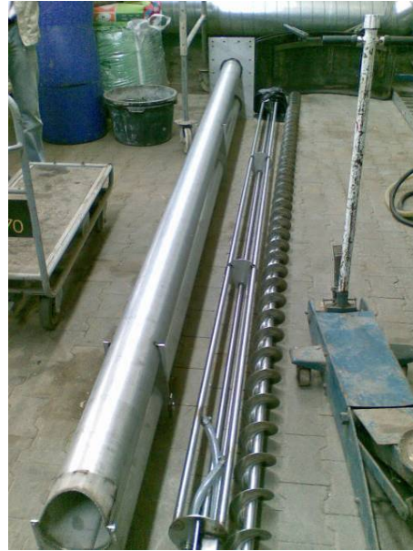
Foto 1.3 Silohaake under etablering: Rustfri snegl og spulesystem, der bygges ind i silobunden gennem to stålør.
