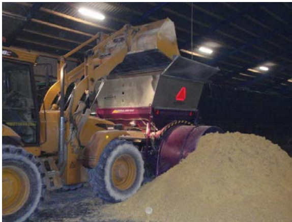
Foto 1.22 Murska crimper i planlager. En dyngje majs ved crimperens afkast giver modtryk og forbedrer erfaringsmæssigt crimpningsgraden.
