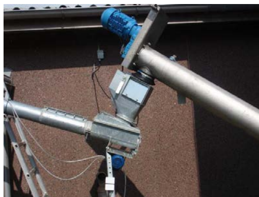
Foto 1.9 Sneglen fra siloen afleverer majs i en ny snegl, der transporterer majs videre ind til møllen. I overgangen mellem de to snegle er der indsat en ventil, der skal sørge for at holde systemet gastæt.
