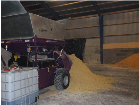
Foto 1.20 Murska crimper, her i planlager - kan også anvendes til silopose. Forrest ses pallettanke med ensileringsmiddel, som tilsættes via dysse i crimperen.
