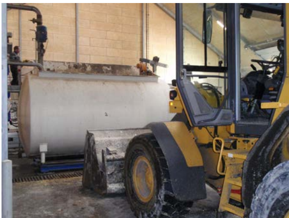
Foto 1.29 Dosering. I en besætning, der i forvejen anvendte mange biprodukter, blev den ensilerede kernemajs doseret direkte i den horisontale blandetank.
