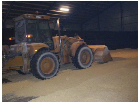
Foto 1.15 Komprimering: Majs blev lagt ind i tynde lag som blev komprimeret = trykket grundigt sammen via kørsel med en gummiged
