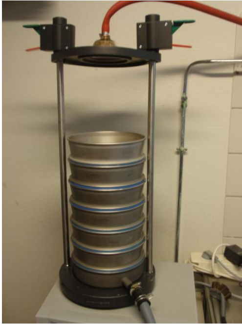
Foto 1. Vådsigtningsskema med 7 solde og vandgennemstrømning, mens soldene røstes i to minutter.
