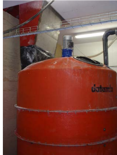
Foto 1.36 Et blandekar på vejeceller modtager ensileret kernemajs fra en Cormall fuldfoderblender. I blandekarret opblandes majs med vand og valle til en forblanding, som pumpes frem til fuldfoderblandekarret.
