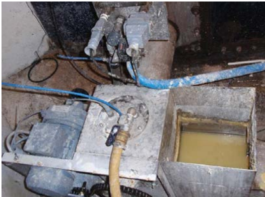
Foto 1.4 Sneglen fra siloen afleverer majs i en lille beholder, der også fungerer som vandlås, således at der ikke trænger CO 2 ud af siloen.
