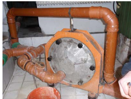
Foto 1.5 Slaglemølle til vådformaling af majs. Der tages majs ind fra begge sider for at få et jævnt slid på slaglerne.
