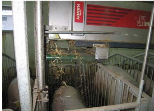
Foto 4. Under ministrøen ses det lille tværgående grønt bånd, som sikrer at halmen falder ned ved soens hoved og ikke på ryggen.
