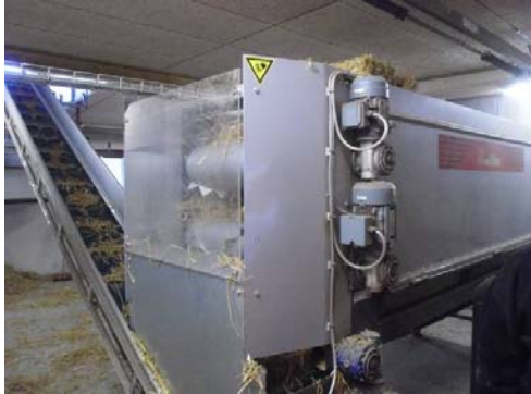
Foto 3. Opriver og påfyldningsenhed til halmopfyldning af JH Mini-Strø op.
