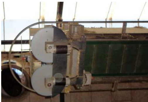
Foto 5. JH Mini-Strø set nedefra med spredetallerken som blev anvendt i drægtighedsstalden i besætning 2. Det grønne bånd til højre i billedet er fremføringsbåndet.
