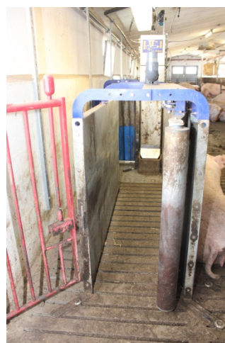
Figur 8. Indgangsforhold ved foderstationen fra Skiold med en sidehængslet låge.
