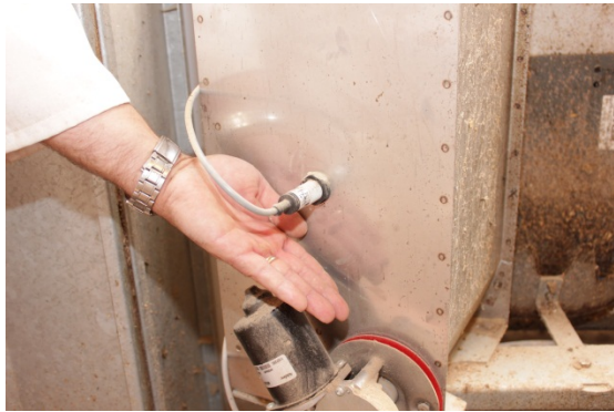
Figur 15. Bopil – hånden angiver den skrå bund i foderbeholderen der afhjælper brodannelse. Endvidere sidder der en tommelder over hånden.
