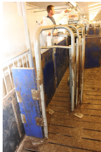
Figur 6. Indgangsforhold ved foderstationen fra Big Dutchman med en sidehængslet låge.
