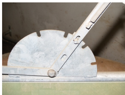
Figur 4. Håndtag til regulering af åbningshøjde (mellem hule og soens område). 1: Lukket; 2: Åbningshøjde 15,5 cm; 3) Åbningshøjde 22, cm; 4) Åbningshøjde 30,0 cm; 5) Åbningshøjde 42,0 cm.
