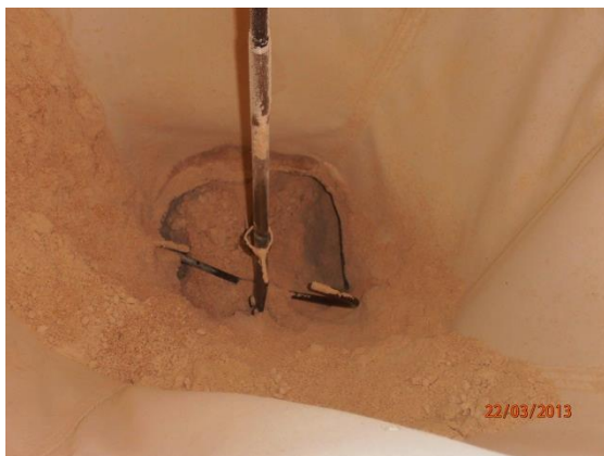
Foto 4. Indvendig side af færdigvaresilo, hvor der er påmonteret en pose fra en "billig" silo. En omrører blev eftermonteret som følge af problemer med brodannelse ved 20 % våd kernemajs i færdigfoderet. Omrøreren kørte hvert 15. minut.
