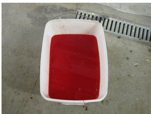
Der blev til vådfoder-testene anvendt rød farve opblandet i vand, svarende til en opløsning af antibiotika.
