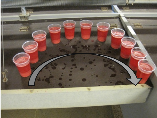
3) Under tømningen af automaten blev der løbende udtaget prøver i glas, som efterfølgende blev tilsat vand. Det først udtagne står til venstre. Her er opnået en meget ensartet fordeling af farve.
