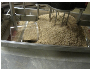
2) Foderautomaten blev tømt i portioner á ca. 2 kg og der blev udtaget en prøve af hver portion i et glas.
