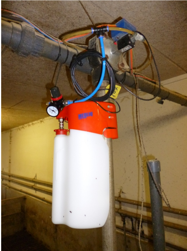
Figur 1. Medliq® monteret på nedfaldsrøret til krybben.
