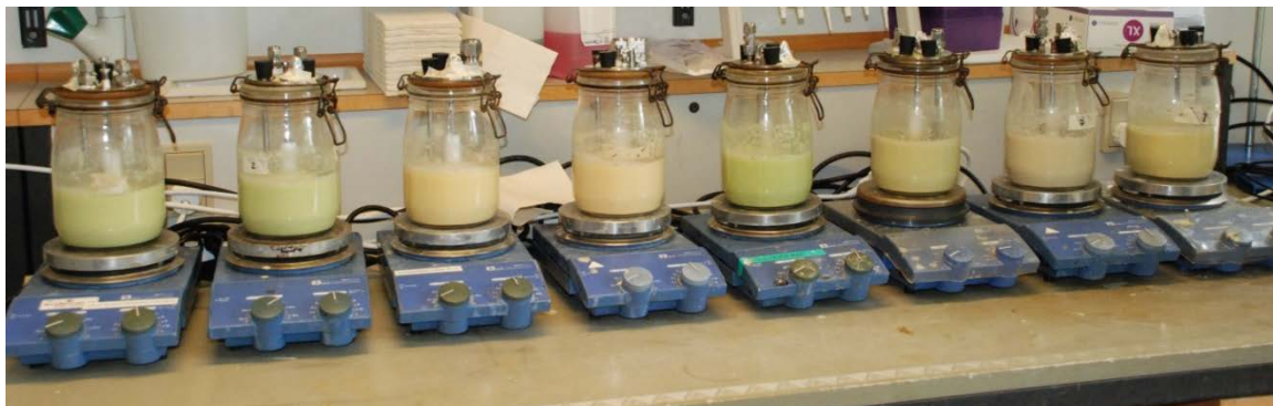
Foto 1. Fermenteringstest i bioreaktorer på laboratoriet i Foulum.
