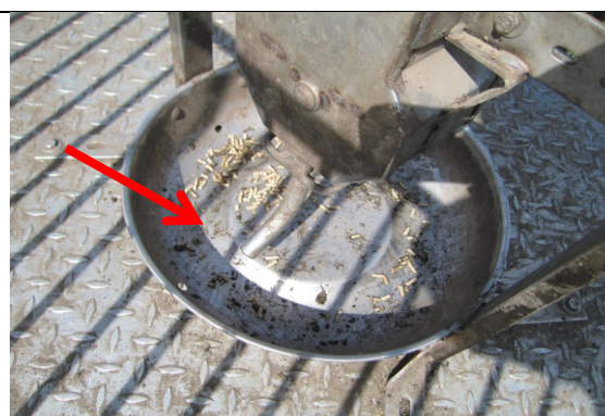
Foto 7. Grisene skal skubbe til pendulet for at få foderet til at falde ned i krybben.
