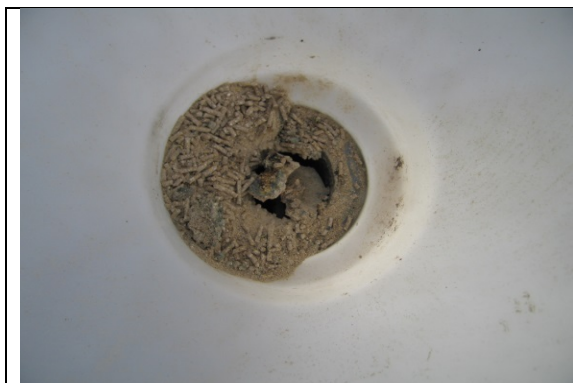
Foto 4. Eksempel på foderkage i bunden af foderbeholder på en tørfoderautomat. Dette blev observeret ved begge fabrikater.
