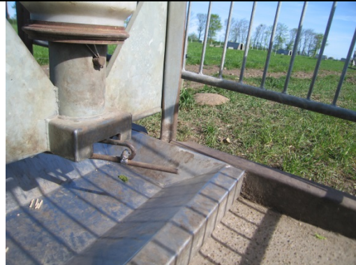
Foto 2. Tørfoderautomat fra BK Teknik & Smedie (BK-automat) placeret i farefolden, jf. figur 1. Foderet faldt ned i krybben, når grise skubbete til pendulet, som ses på fotoet til højre. Foderautomaten er ikke i produktion.
