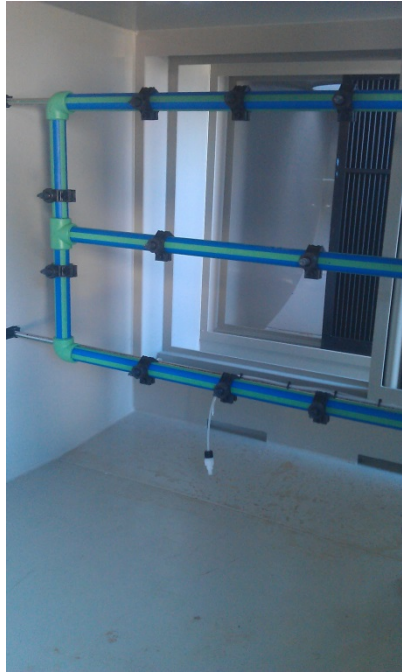
Figur 3. Dysebom til opfugtning af luften med svovlsyre opløst i vand.
