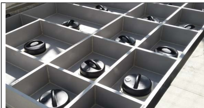
Figur 3. Gødningsopsamlingsbakke med gylleprop i hvert rum.
