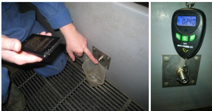
Billede til venstre: Kontrolmåling af vandydelsen i 30 sekunder. Billede til højre: Måling af vandtryk med manometer.
