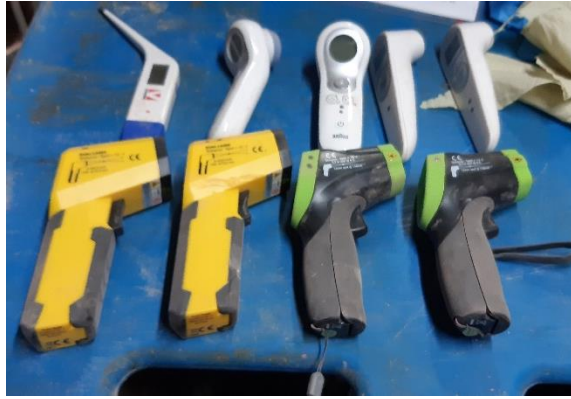
Figur 2. Termometre anvendt i tredje og fjerde fase. Fra venstre øverste række: Kruuse 1; Braun 1; Braun 2; Microlife 1; Microlife 2; Nederste række fra venstre: Gul Trotec 1; Gul Trotec 2; Grøn Elma 2; Grøn Elma 1. Yderst til højre: Braun-øretermometer, hvor Kruuse 1, Microlife 1, Microlife 2 også blev anvendt i fase 4 og Braun (øre) kun i fase 4.
