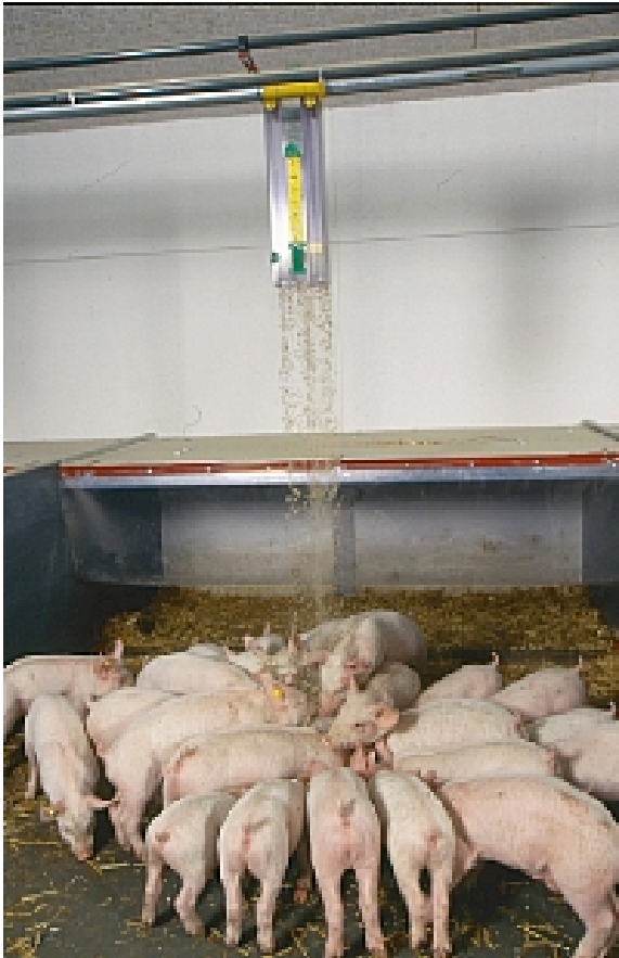
Foto: Ekstra foderstreng med volumendoserer til gulvfodring (billededatabase nr. 4113)
