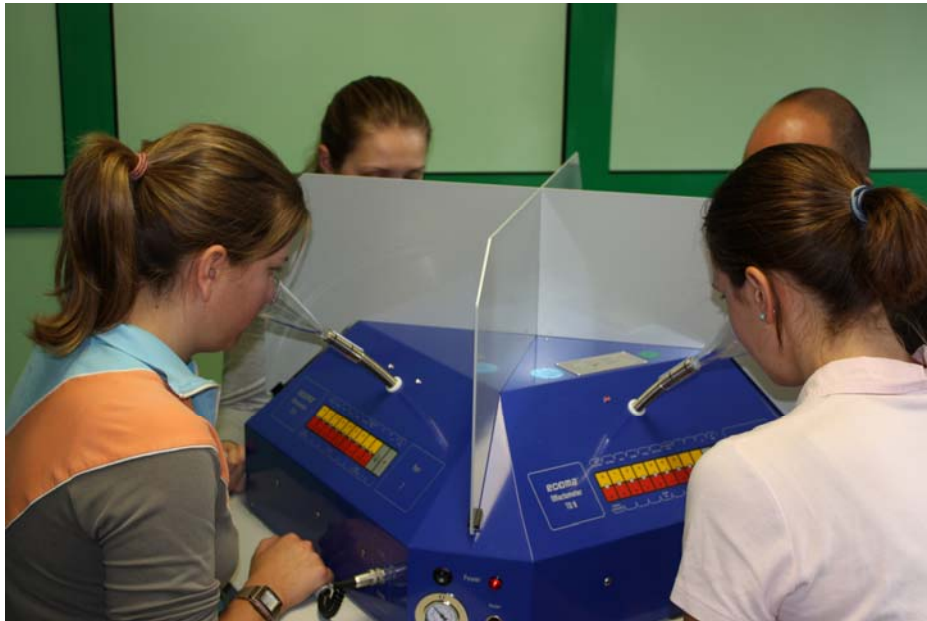
Figur 4. Efter udtagning af lugtprøve blev en 30 liters pose sendt til analyse på lugtlaboratorium, hvor lugtprøven blev analyseret på olfaktometeret Ecoma T0 8.
