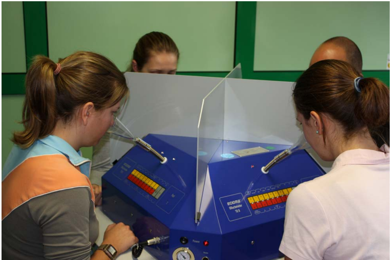
Figur 5. Efter udtagning af lugtprøve blev en 30 liters pose sendt til analyse på lugtlaboratorium, hvor luftprøven blev analyseret ved hjælp olfaktometeret Ecoma T0 8.
