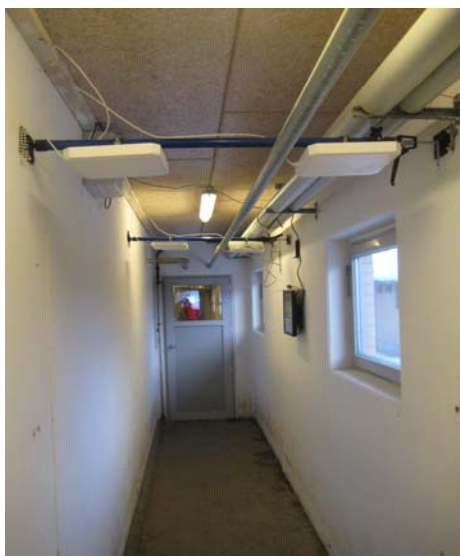
Figur 5: Læseropstilling til stationær læser (bemærk touchskærm til betjening på væg) (tv). Boks til beskyttelse af læsemodul (th).
