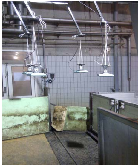
Figur 8: Stationær læser ved læsserampe (tv). Kobling af grisens øremærke og slagtenummer på slagtelinien (th).
