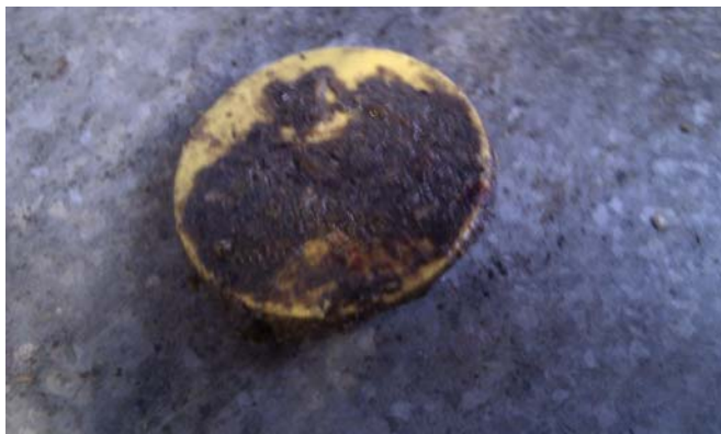
Figur 4: Elektronisk øremærke med nedsat læsevne pga gødningsforurening (tv) og beskadiget elektronisk øremærke pga bid (th).
