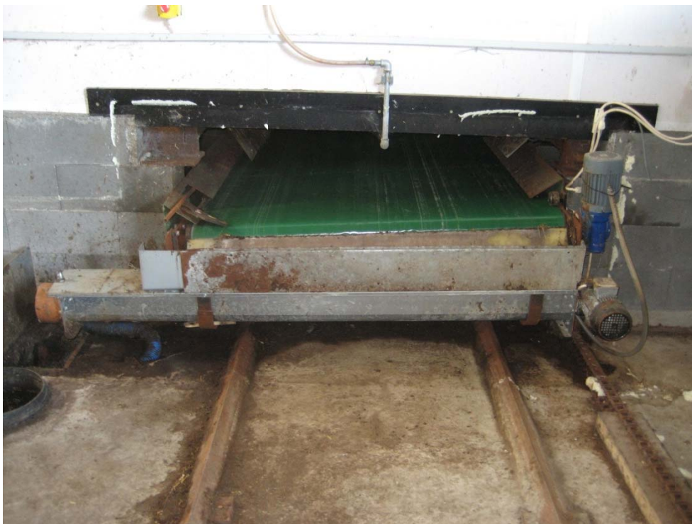
Figur 2. Gødningsbånd til separation af fæces og urin inde i stalden.
