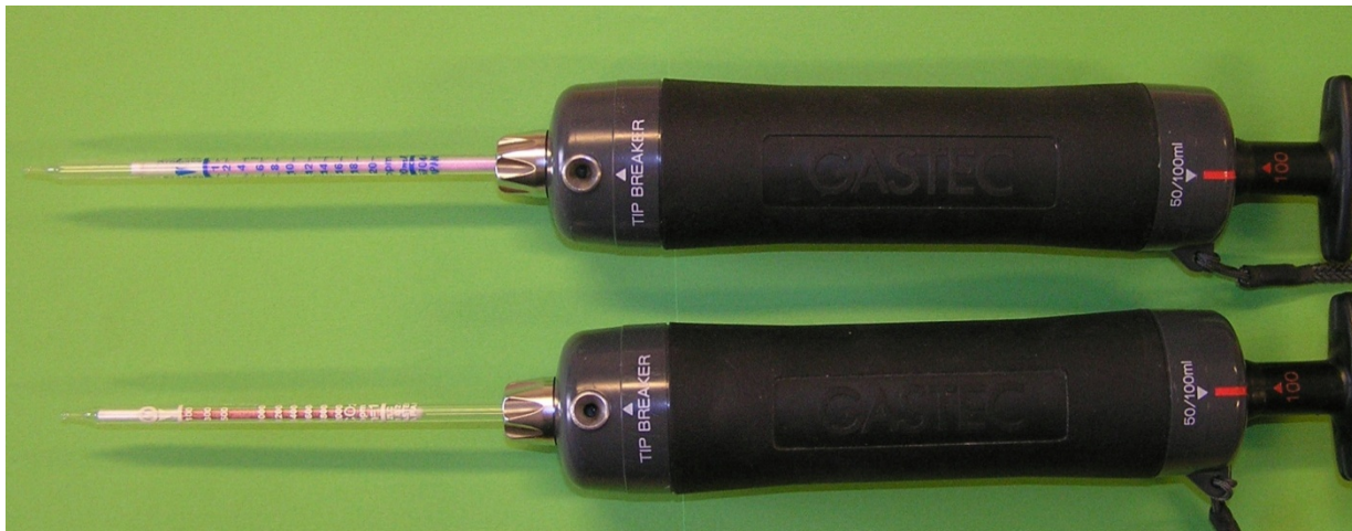
Figur 6. Måling af ammoniak- og kuldioxidkoncentration blev foretaget med sporgasrør af fabrikatet Kitagawa. Ammoniakmåling ved sporgasrør sker ved en kemisk reaktion. I det viste ammoniakrør Kitagawa 105SD var det en reaktion af ammoniak med fosforsyre. Detektionsgrænsen var på 0,2 ppm for ammoniakrøret. (Billedbase: 0181)
