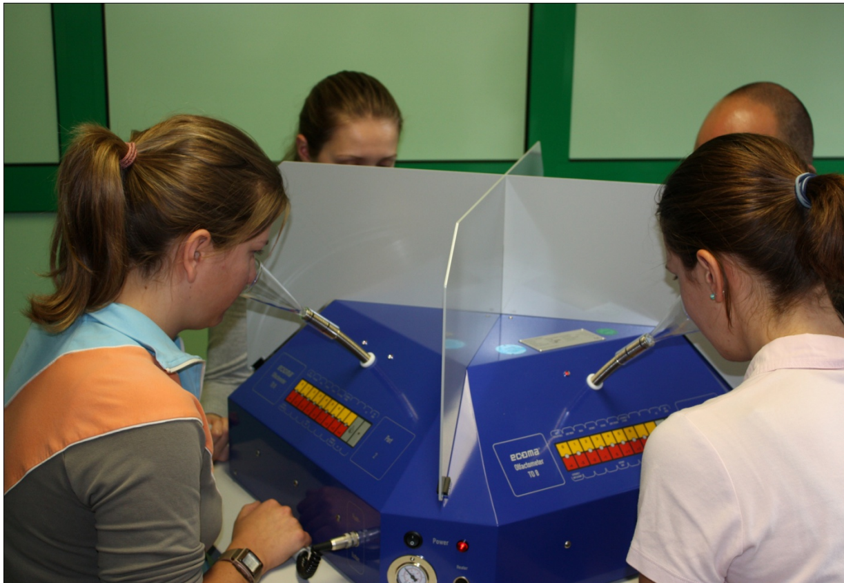
Figur 5. Efter udtagning af lugtprøve blev en 30 liters pose sendt til analyse på lugtlaboratorium, hvor luftprøven blev analyseret ved hjælp olfaktometeret Ecoma T0 8.
