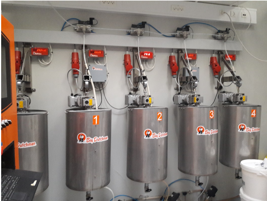
Figur 6. Forsøgsanlæg med 5 blandetanke og en fodercomputer.
