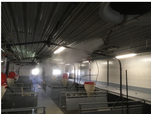
Figur 3. Forstøvning af biocidet UDF2 fra dyse i loftet i de to forsøgssektioner (sektion 1 og 2). Forstøvningen skete dagligt gennem hele forsøgsperioden på seks uger.
