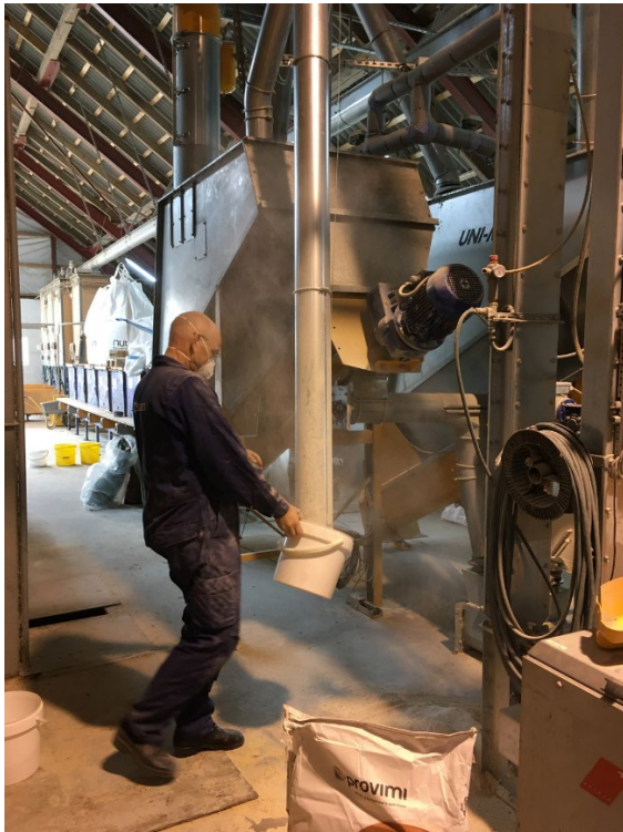
Foto 5. Udtagning af formalet korn under transport fra møllen ved hjælp af klappkasse
