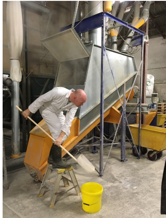
Foto 6. Udtagning af formalet korn under indløbsrøret i foderblender
