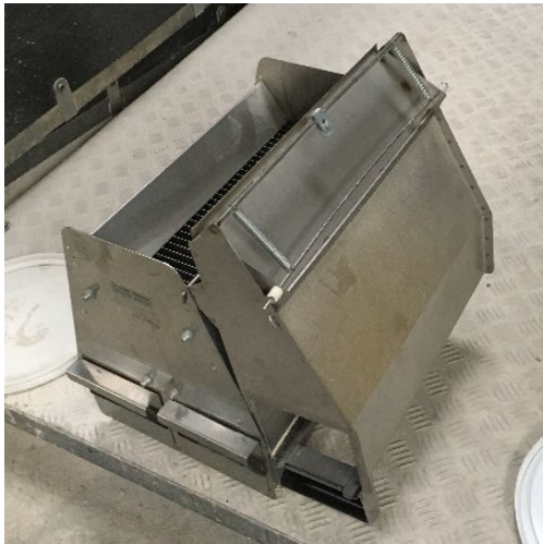
Foto 1. Spalte-neddeler blev anvendt til at dele prøverne i ens delprøver
