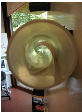
Figur 6.2. Vådfoderrør med indvendig spiral, der sørger for at tunge partikler ikke bundfældes under transporten.
