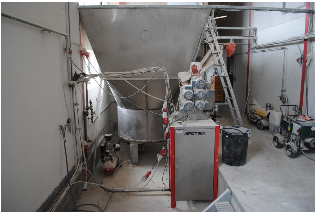
Figur 6. Spotmix foderanlæg. Majsen påfyldes via påslag i gavlen og blandes med tilskudsfoeder.
