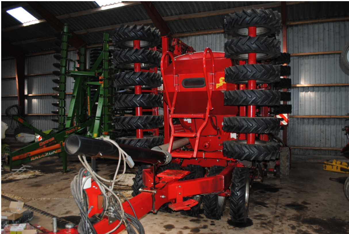
Figur 2. Majssåmaskine. Bagved står en tallerkenharve der anvendes til jordbehandling på majsarealet.
