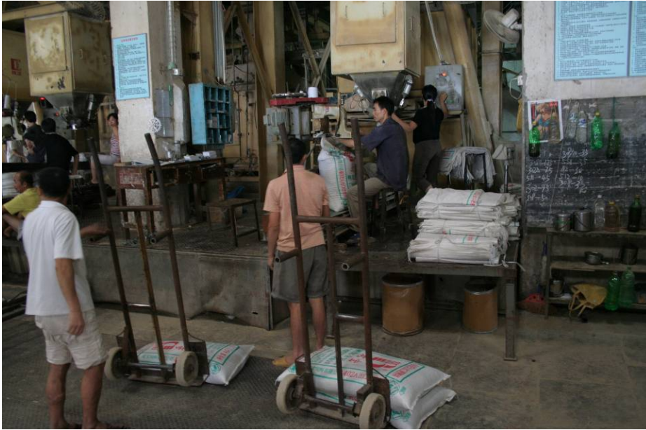
Fodersækkene lukkes med symaskine (midt i billedet) og køres på sækkevogne 10 sække á 50 kg!
