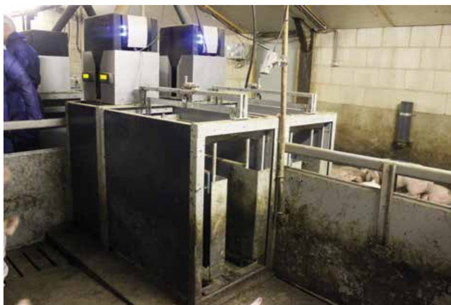
Automat til registrering af individuelt foderforbrug.
