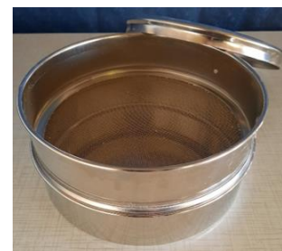
Skiold-håndsigte med 1 mm sold. Sigtetid 2 minutter. Velegnet til alle dyregrupper.
