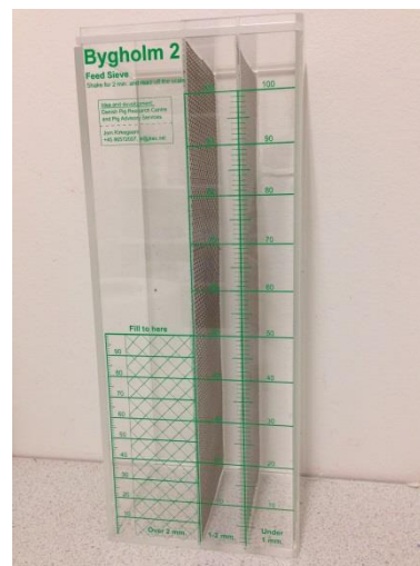
Bygholmsigte 2: Til bestemmelse af formalingsgraden af kornet.
