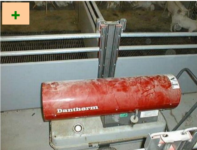
Udtørring med varmekanon (7368)
