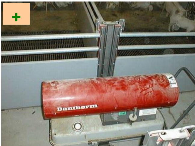
Udtørring med varmekanon (7368)
