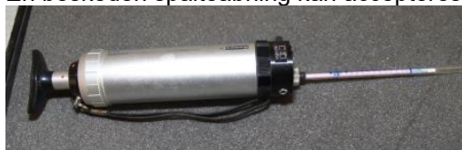
Pumpe og rør til måling af ammoniak
