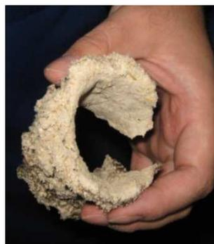
Отложения в вертикальных трубах дозаторов можно удалить с помощью щетки или промыванием
