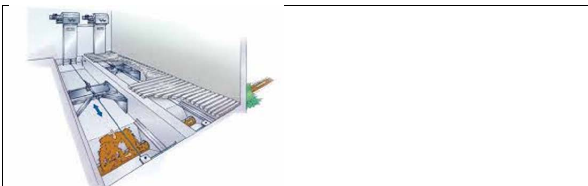
Figur 3. Eksempel på et linespilsanlæg til hyppig udslusning af gyllekanaler. Linespilsanlægget trækker gyllen til en tværkanal, hvorfra den pumpes til udendørs-lager.
