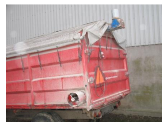
Transportvogn med tømmesnegl – vognen tippes og foderet snegles ud i bunden
