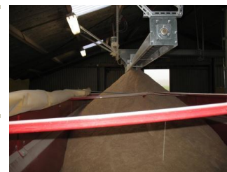
Fyldning af transportvogn med åben sneglerende
