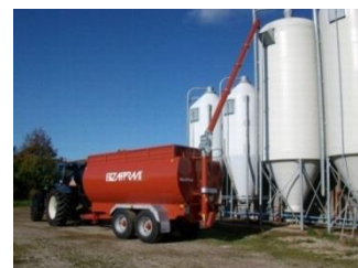
Direkte opfyldning af silo med justerbar snegl
