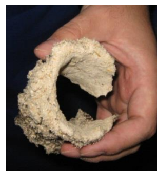
Belægning i nedfaldsrør fra volumenkasse kan fjernes med børste eller ved vask
