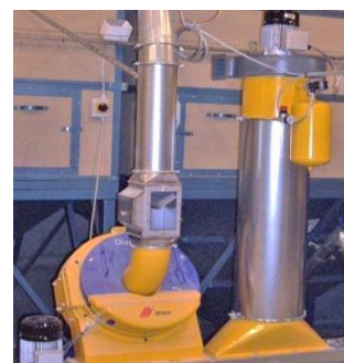
Skivemølle (med dysefilter). Større møller (stort møllehus) kan bedre håndtere vådt korn.
