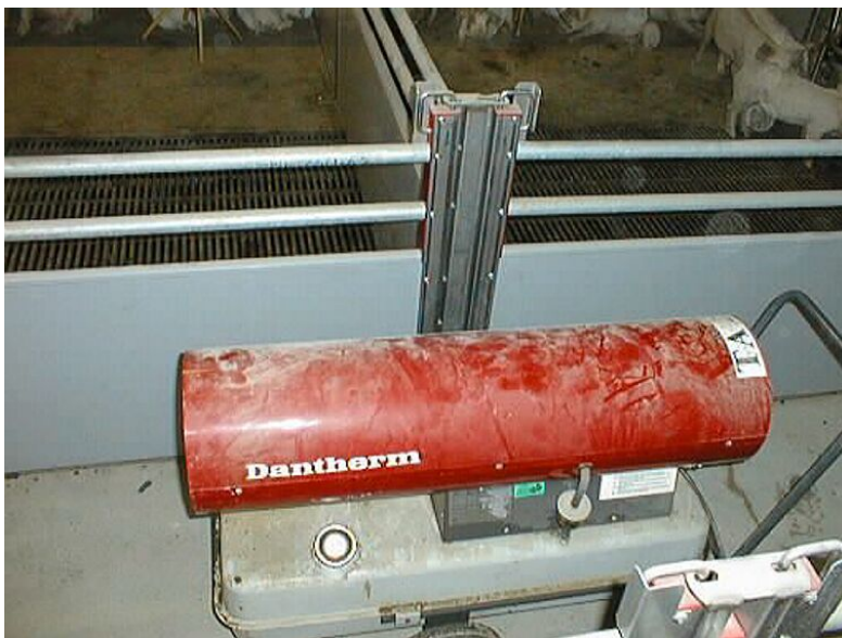
Udtørring med varmekanon (7368)
