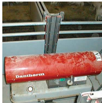
I en stald på ca. 200 m 2 skal der typisk anvendes ca. 75 liter olie for at udtørre stalden.
