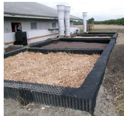
Afprøvning af forskellige filtermaterialer i horisontale filtre.
