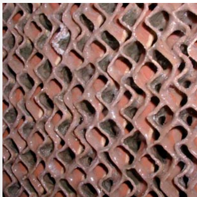
Biofilm på filtermateriale af cellulose.
