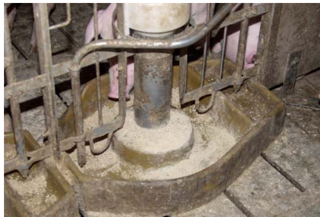
Rørfodringsautomat (Faaborg 3-i-1) med vand og uden vand. Foderoptagelsen reduceres ved at lukke for vandet i rørfodringsautomaten, men det kan kun anbefales ved pelleteret foder, da der er stor risiko for foderspild ved melfoder i rørfodringsautomater uden vand.
