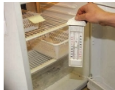
Benyt et min/max-termometer til at kontrollere om sæden opbevares ved 16-18 grader celsius
