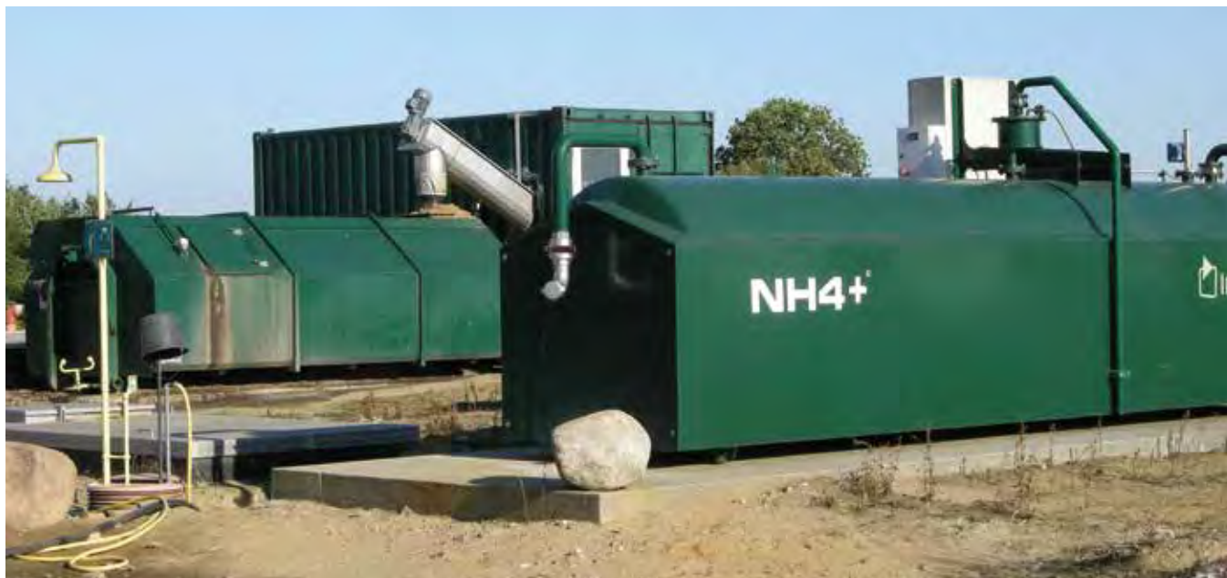
Gyllebehandlingsanlægget SmellFighter fra Infarm A/S.
